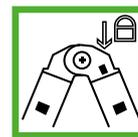
Проверить закрытие шарнирного замка
