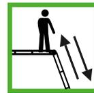
Для подъёма и спуска использовать крайнюю секцию
