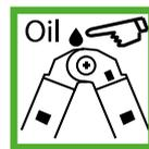
Периодически смазывать шарнирные замки и соединения
